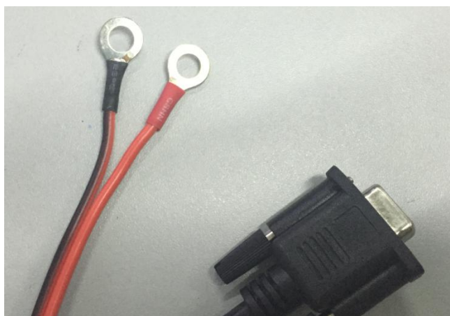
图 4 圆形端子和 DB9 接头
